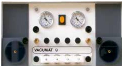
Unidad de vacío para la fabricación de laminados de resina fundida de paredes delgadas y embutición profunda de termoplásticos.
