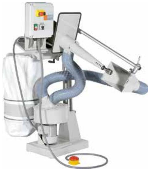
Fresadora con brazo largo, especial para uso ortoprotésico, con sistema de extracción completamente instalado, potencia de extracción de 0,75kw, salida de aire de extracción 1300 m3/h, eje de fresado/motor orientable horizontalmente y regulable en altura, bandeja de recoger virutas multiajustable, potente motor con dos velocidades, freno de motor electrónico, protección de eje desmontable.
