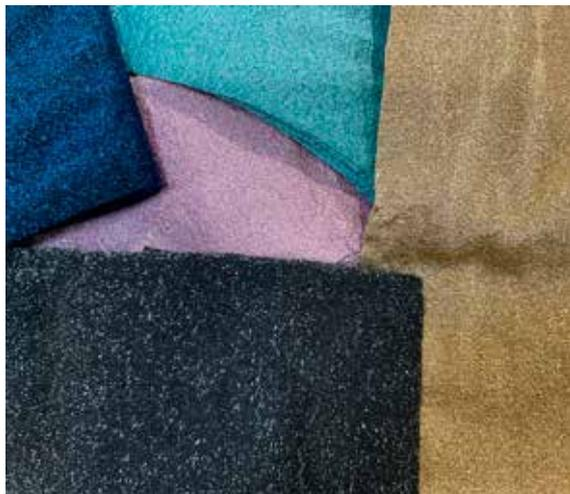
Tubular de perlón, de varios anchos y diseños. El perlón además de dar fortaleza a la estructura, se empapa fácilmente con las resinas.
